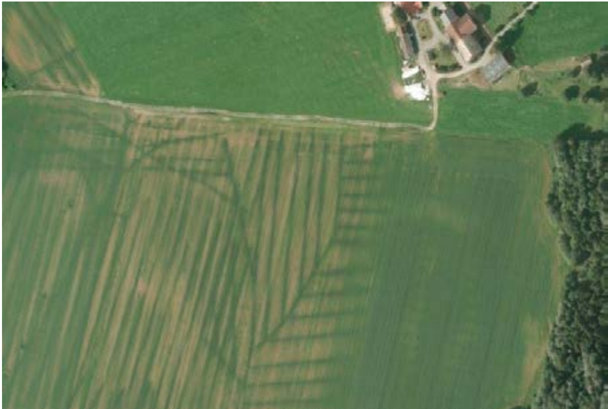
Figur 2.6: Flyfoto som viser drenssystem på et jorde
