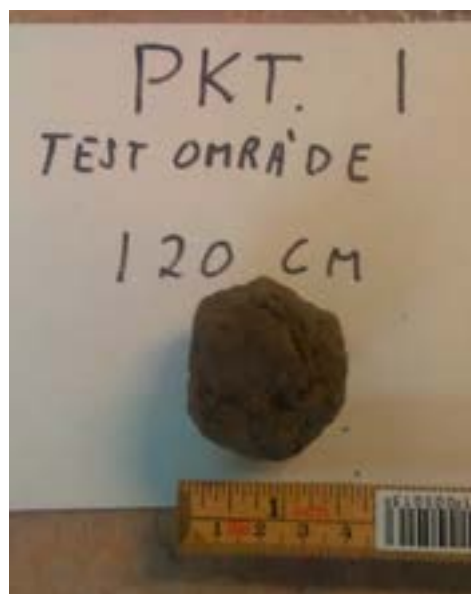
Figur 8: Bilder som viser leire som undersøkes ved rulling av ball og pølse
