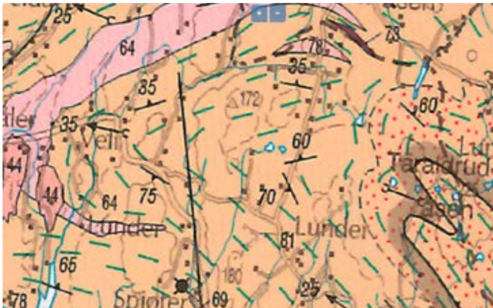
Figur 2.3: Eksempel på kartutsnitt av berggrunn der strøk- og fallretning er vist med symbol. Tallene på kartet angir fallvinkelen målt i forhold til horisontalplanet
