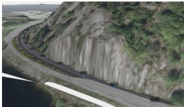
Figur 29 Høg skjæring som kan medføre vegstengning ved sprengningsarbeid
