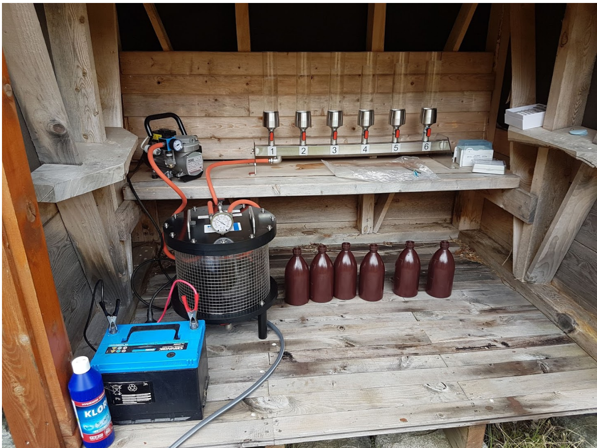
Foto. Mobil filtreringsstasjon for filtrering av vannprøver i felt. Metoden er utprøvd og brukt i kombinasjon med Franklin Real-Time qPCR thermocycler (Biomeme). Foto: Trond E. Isaksen
